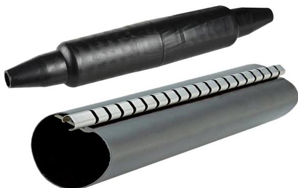
Разветвительные муфты с манжетами ТУМ предназначены для восстановления оболочек на кабелях ТППЭп, ТПппЗП, ТППЭпЗ и т.д. Муфты, смонтированные с использованием термоусаживаемых манжет, могут устанавливаться под постоянное избыточное воздушное давление. Подбор разветвительных муфт с ТУМ следует производить с учетом ёмкости сращиваемых кабелей, типоразмера муфты и типов используемых соединителей.
