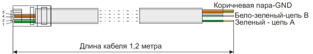
Альтернативная схема заделки кабеля в коннектор RJ45-8pin допустима, т.к. контакты 1-3, 2-6 и 4-5 внутри прибора соединены.
