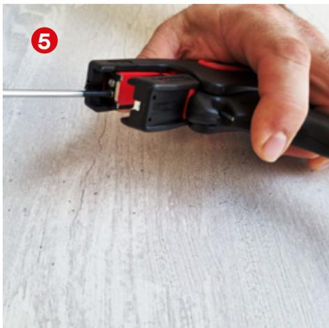
Установите новые лезвия и зафиксируйте их с помощью 4-х шурупов.
