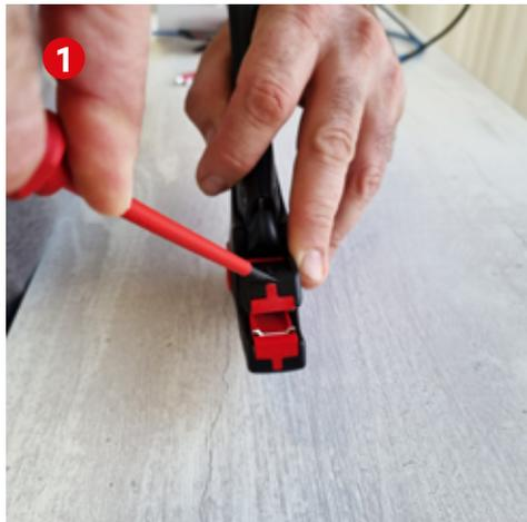
Извлеките ограничитель из нижней направляющей. Для этого переверните инструмент рукоятками вверх и с помощью тонкой отвертки с плоским шлицом выдавите нижний ограничитель.
