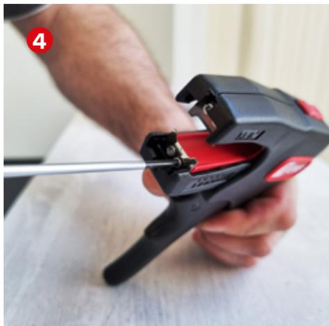
С помощью крестовой отвертки выкрутите 4 винта, фиксирующие верхний и нижний ножи.
