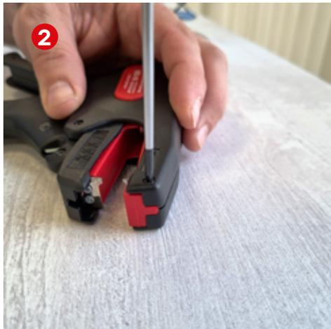
Извлеките ограничитель из верхней направляющей. Для этого положите инструмент на бок и с открутите фиксирующий ограничитель шуруп
