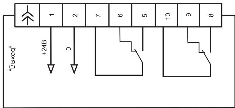
С помощью мегаомметра проконтролируйте разомкнутое состояние контактов 8,10 и с помощью омметра - замкнутое состояние контактов 5,7 разъема «Выход».
