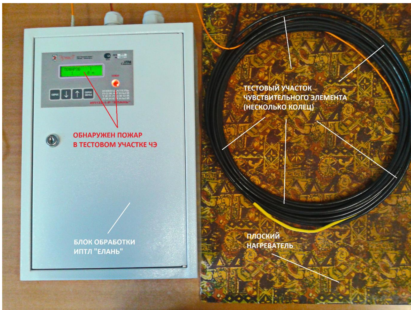
Рис.3.11. Пример использования плоского электрического нагревателя для качественного определения работоспособности ИПТЛ «Елань»
