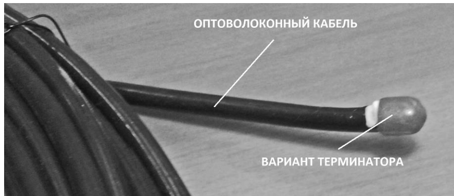
Рис. 3.9. Вариант терминатора в сборе на оптоволоконном кабеле
