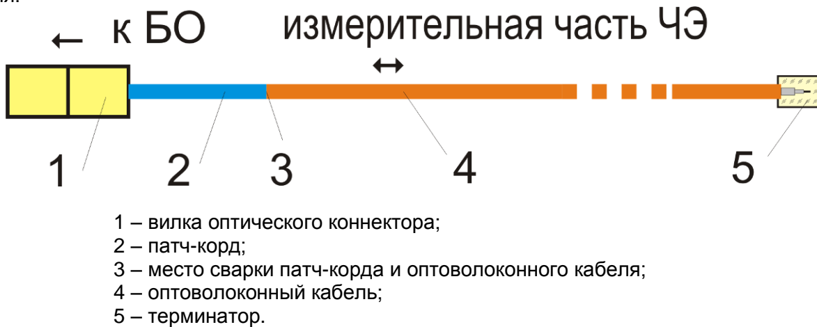
Рис. 3.7 - Составные части чувствительного элемента.
