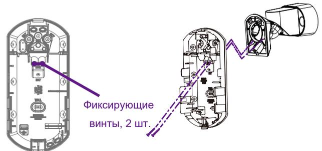
*Для крепления кронштейна обычно требуется 3 отверстия и 3 соединительных винта.*
