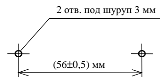
Рис. 1- Разметка для крепления извещателя
