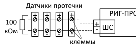
Рис. 2 Подключение четырех датчиков протечки
