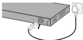
Подключение питания AC 100~240В
