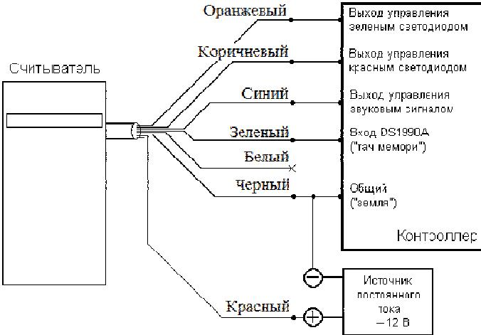
**Схема подключения считывателя в режиме Wiegand**
