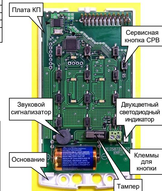
Наберите на КП код пользователя (4 цифры) и нажмите «#», инициировав передачу посылки на прибор. Прибор, получив эту посылку, обрабатывает её и выдаёт результат:
