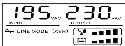
Когда устройство находится в режиме зарядки, оно отображается следующим образом.
