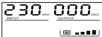
В нормальном режиме он отображается следующим образом.
