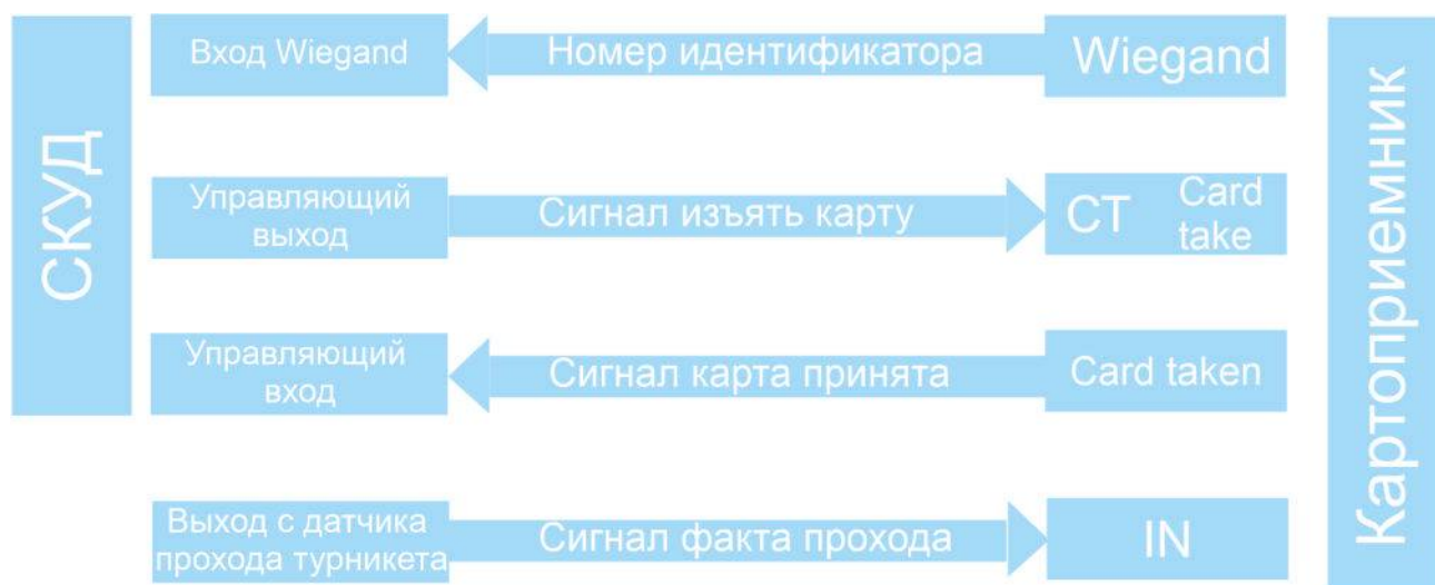
Рисунок 6.2.1 Алгоритм работы картоприемника
