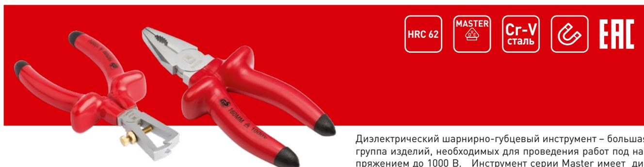
Диэлектрический шарнирно-губцевый инструмент – большая группа изделий, необходимых для проведения работ под напряжением до 1000 В. Инструмент серии Master имеет диэлектрическое покрытие (изоляция), нанесенное методом погружения. Инструмент серии Expert имеет насадную диэлектрическую изоляцию с элементами защиты от соскальзывания.
