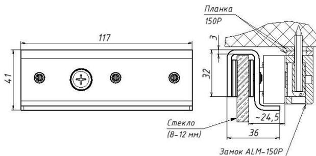
Рисунок 2 - Габаритный чертеж комплекта МК 150-GLU
