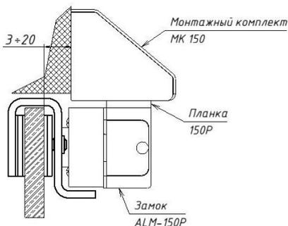
Рисунок 3 – Установка замка ALM-150P на
