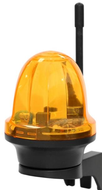
Миниатюрная сигнальная лампа ST-RB002FL предназначена для световой сигнализации о движении стрелы шлагбаума или ворот. Дополнительно лампа имеет встроенную антенну для увеличения дистанции приема сигнала от передатчиков, может использоваться с любым приемником, работающим на частоте 433,92 МГц. В комплекте идет угловой монтажный адаптер для крепления на вертикальную поверхность.
