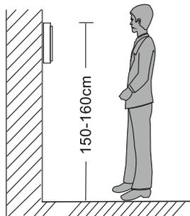
Схема монтажа монитора
