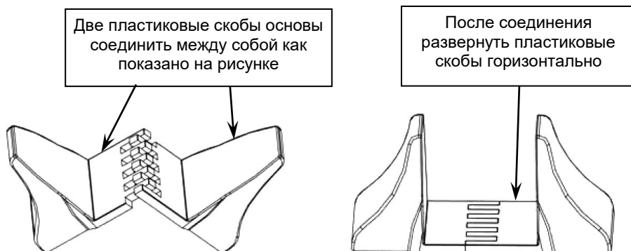
Рисунок 3 - Сборка пластиковых основ для вертикальной установки изделия.
