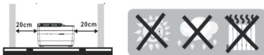
Figure 1. Posizionamento dell' UPS
