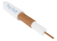
miniПаракс™ PK 75-3-32 - радиочастотный кабель с однопроволочным внутренним проводником и внешним проводником в виде оплетки из медных проволок. Изоляция выполнена из пористого полиэтилена, полученного методом физического вспенивания,оболочка из ПВХ пластиката белого цвета. Конструкция аналогична кабелям типа 3C-2V.
