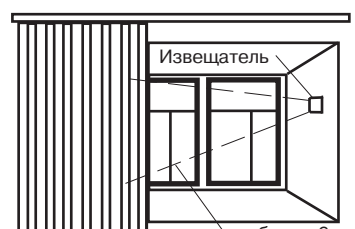
Рисунок 8 – Установка извещателя между стеклом и занавесями (жалюзи)
