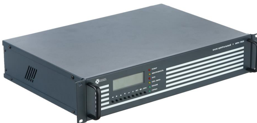
Рисунок 4. Внешний вид ЦБ МЕТА 19830.
