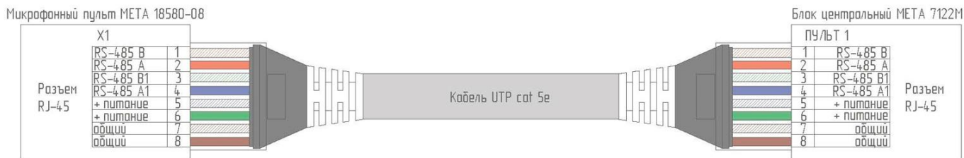
Рисунок 20. Схемы подключения кабеля от МП к ЦБ.
