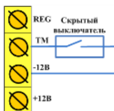
Рисунок 3.2 — Схема подключения скрытого выключателя
