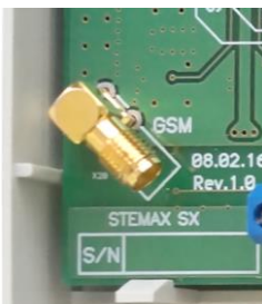
Рисунок 3.1 — SMA-разъем для подключения GSM-антенны
