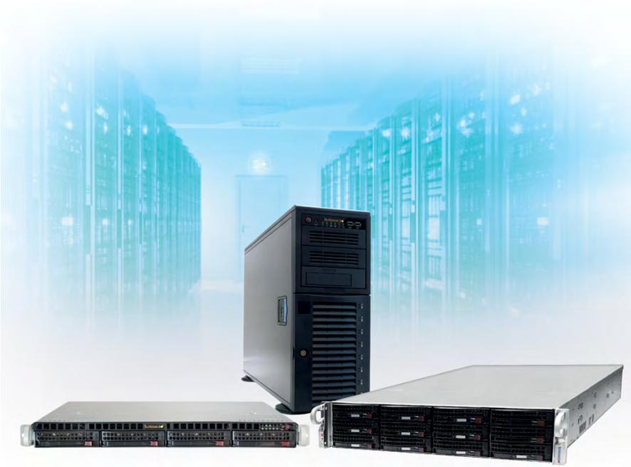
Сетевой видеосервер для систем IP-видеонаблюдения. Предназначен для записи изображения, полученного с IP-видеокамер, воспроизведения из архива и трансляции видеоданных на удаленные рабочие места. Видеосервер состоит из аппаратной платформы и программного обеспечения.
