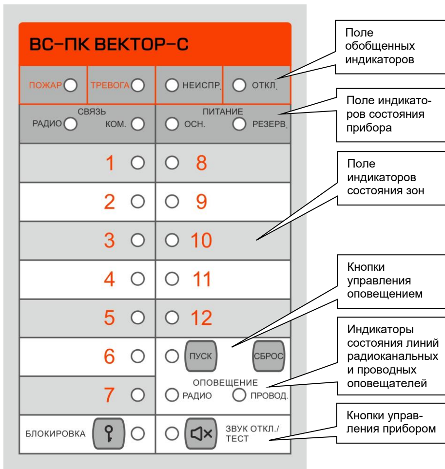
Рис.1. Внешний вид панели индикации и управления прибора.
