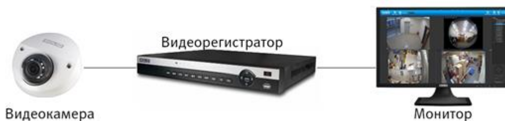
Рисунок 6.2 – Схема подключения видеокамеры
